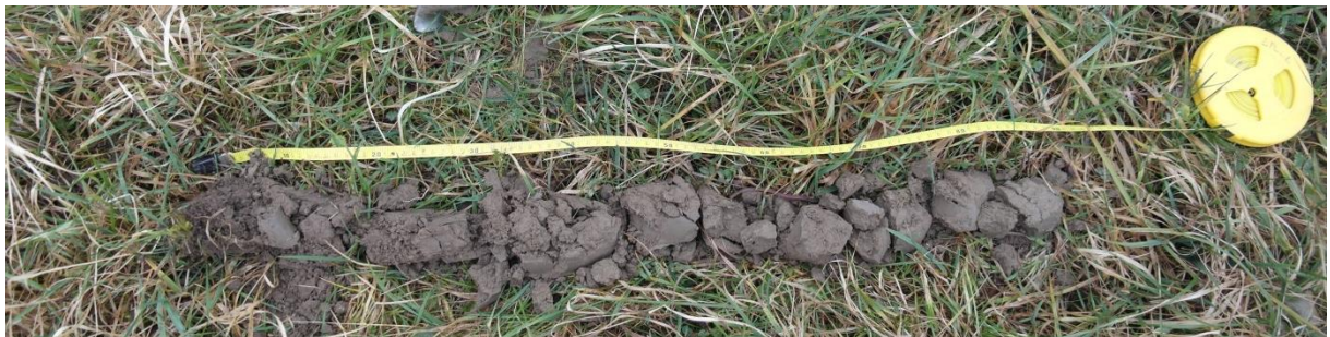
Exemple de carottage : Sondage n°1 : sol non humide
