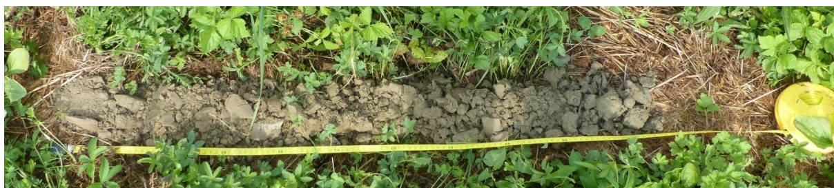
Exemple d'un forage :- Carotte avec de très légères trace réductique à partir de 110cm
